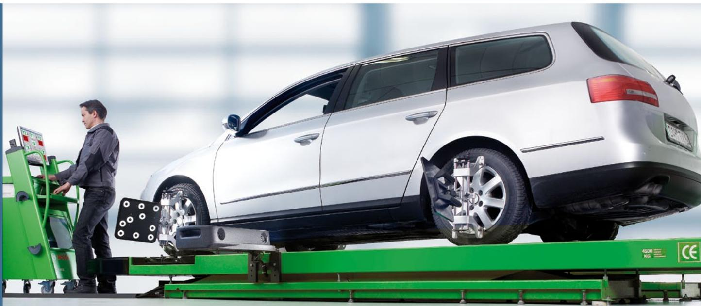
Безупречный результат: Измерения производятся практически сразу после установки измерительных блоков и мишеней.
