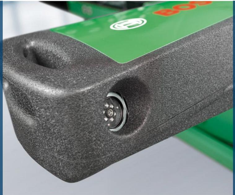
Измерительный блок со стереокамерами
