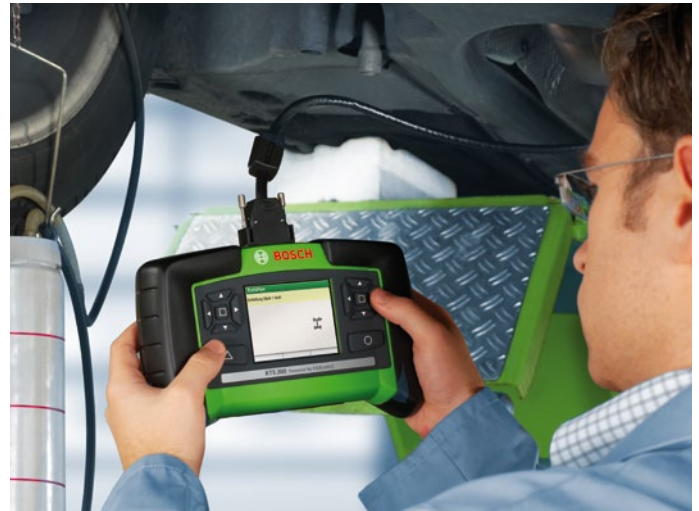
Прокачка тормозов: воздух удаляется нажатием кнопки
