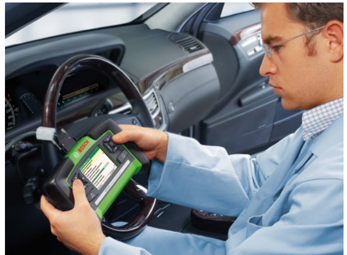
Проверка масла: состояние и качество наглядно отображаются на экране
